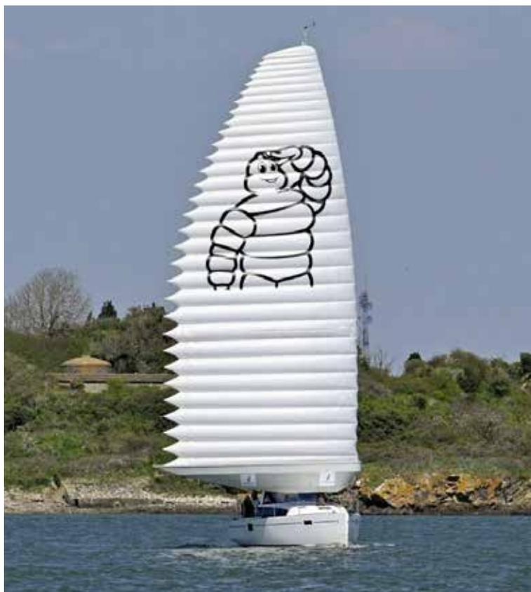
L'**aile Wisamo** (pour Wing Sail Mobility) est une aile gonflable conçue pour les navires de commerces et de plaisance, développée par une start-up nantaise du Groupe Michelin. Son but ? **Décarboner le transport maritime** ! Le prototype de cette aile gonflable automatisée et son mât télescopique sont visibles à bord du *Wind of Change*, le voilier du célèbre navigateur Michel Desjoyaux.
