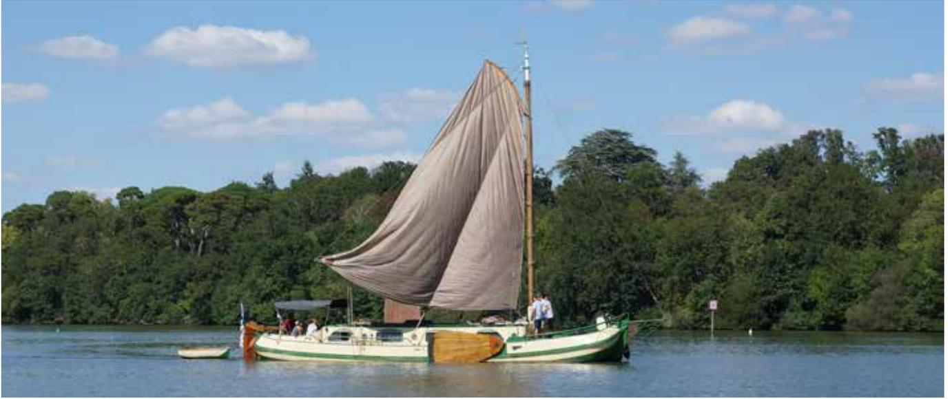
À l'origine **bateau de charge des canaux néerlandais**, ce voilier de 20 tonnes, à coque à clins rivetés et bouchains arrondis, a été facilement converti à la voile. Réactif et sain, il devient **bateau de plaisance** dans les années 1950. En 2011, *Cornelia* arrive en France et navigue depuis en Bretagne, le long des côtes et voies d'eau intérieures.
